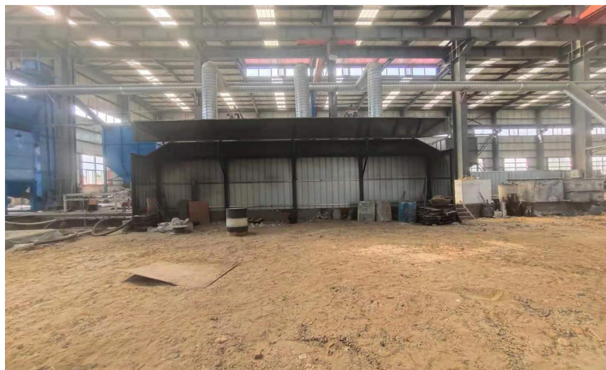
图 3-2 浇铸工序与清砂工序安装集气罩
