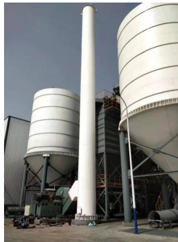
图3-8 成品包装、筛分布袋除尘器
